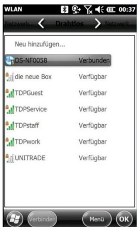
Nach wenigen Sekunden wird die DS-200i als <Verbunden> angezeigt; Fenster mit [OK] schließen
