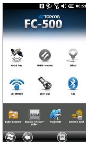
Auf dem Desktop ist nun das WLAN-Symbol blau. Darunter wird die Seriennummer der DS-200i angezeigt.
