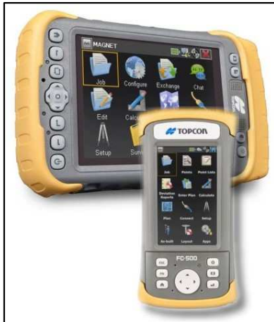
Beispiel für Windows Mobile-Feldrechner: Topcon Tesla (Hintergrund) und FC-500.
