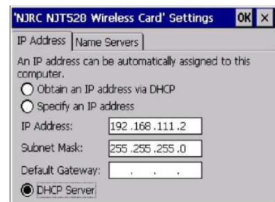
[IP-Adress] und [Subnet Mask] eingeben; Vorgaben können übernommen werden. [DHCP Server] aktivieren; [OK]
