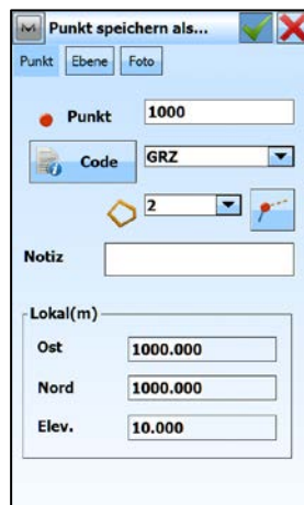
Koordinaten des Standpunktes werden angezeigt. Mit [✓] akzeptieren
