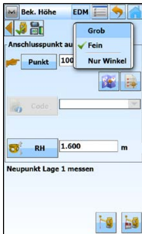
Ersten Höhenanschlusspunkt und Reflektorhöhe eingeben, EDM-Modus auswählen und messen
