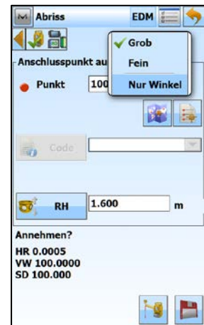
Ersten Abrisspunkt, Reflektorhöhe und EDM-Modus eingeben und Punkt messen
