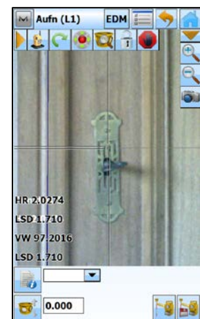
Gewünschten Punkt messen. Das Foto vom Punkt wird mit abgespeichert.
