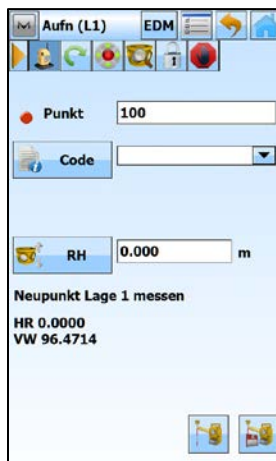
[]-Button drücken zur Aktivierung der Prismen-Suche und Umstellen auf Live-Video
