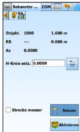
Anschlussrichtung setzen mit [Setzen]
