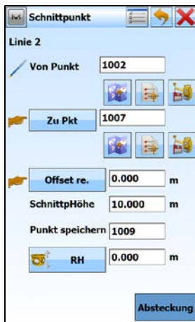
Linie 2 überprüfen, Reflektorhöhe eingeben und Schnittpunkt abstecken [Absteckung]
