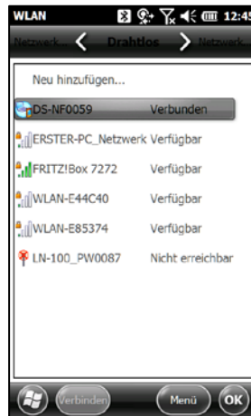
Nach kurzer Zeit verbindet sich der Feldrechner mit der Totalstation via WiFi.
