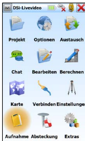
Nach erfolgter Stationierung im Hauptmenü auf [Aufnahme]
