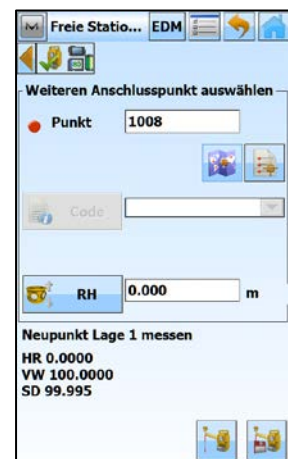
Zweiten Anschlusspunkt und Reflektorhöhe eingeben und messen
