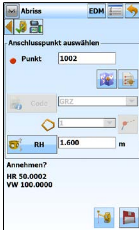
Dritten Abrisspunkt, Reflektorhöhe und EDM-Modus eingeben und Punkt messen
