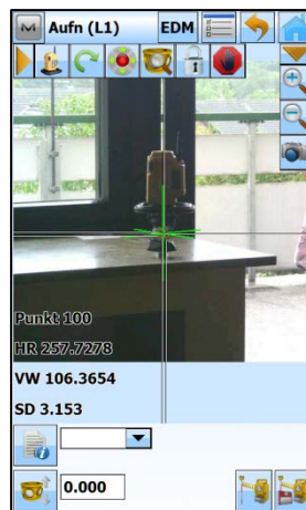
Messung auslösen und speichern
