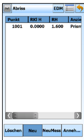
Ergebnis wird angezeigt. Mit [Neu] nächsten Abrisspunkt hinzufügen
