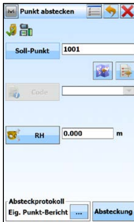
Reflektorhöhe eingeben und Punkt abstecken [Absteckung]
