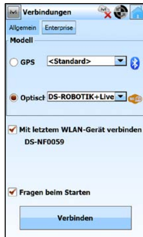
Mit der Totalstation [Verbinden]; wahlweise kann der Haken bei [Mit letztem WLAN-Gerät verbinden] gesetzt werden
