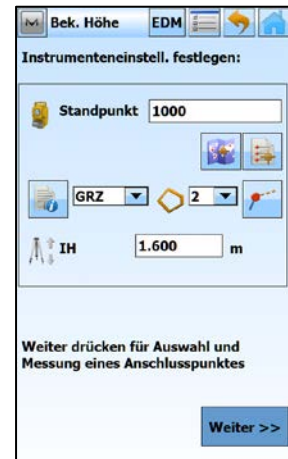
Standpunktnummer und Instrumentenhöhe eingeben und [Weiter]
