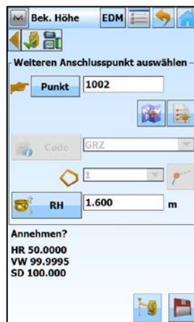
Dritten Höhenanschlusspunkt und Reflektorhöhe eingeben, EDM-Modus auswählen und messen
