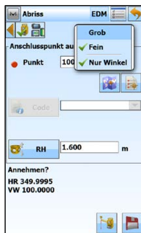
Zweiten Abrisspunkt, Reflektorhöhe und EDM-Modus eingeben und Punkt messe
