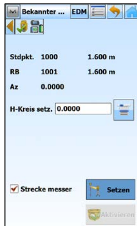
[Strecke messen] aktivieren und Anschlusspunkt messen mit [Setzen]
