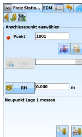
Ersten Anschlusspunkt und Reflektorhöhe eingeben und messen
