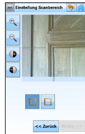
Auf dem Bildschirm die obere linke Ecke auswählen und mit [ ] setzen
