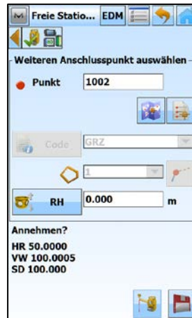
Dritten Anschlusspunkt und Reflektorhöhe eingeben und messen
