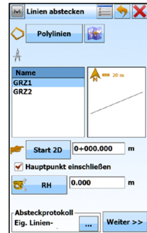
Gewünschte Linie auswählen, Reflektorhöhe eingeben und [Weiter]
