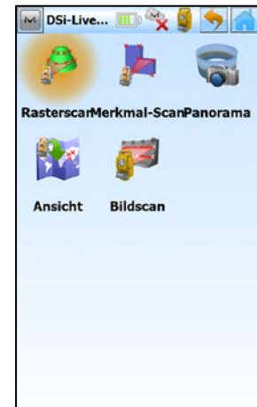
Gewünschte Scan-Art auswählen, z.B. [RasterScan]
