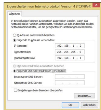
Einstellungen wie oben vornehmen – jeweils angepasst an die Einstellungen in TRU (IP-Adresse, Subnetzmaske und Standardgateway) [OK > Schließen]
