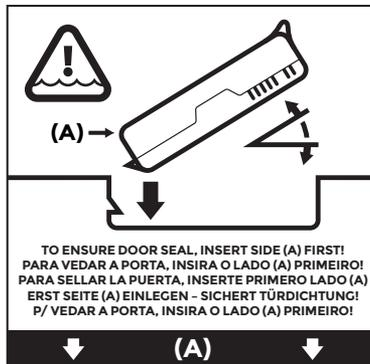
3. Drehen Sie die mit der Lasche versehene Kante nach unten, bis der Akku flach im Fach sitzt.
